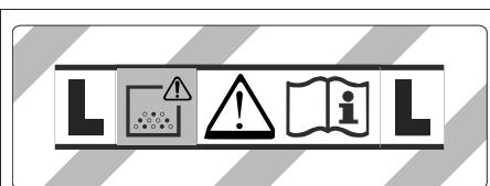
**ПРЕДУПРЕЖДЕНИЕ:** В данном устройстве находится опасная для здоровья пыль. Опорожнение и техническое обслуживание, в том числе, удаление пылесборного мешка, должно проводится только специалистами, носящими подходящее защитное снаряжение. Не включать до полной установки фильтровальной системы.
